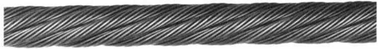
Toronnage «Lang» à Gauche – Les torons se dirigent vers la gauche et les brins font un angle avec le câble.
