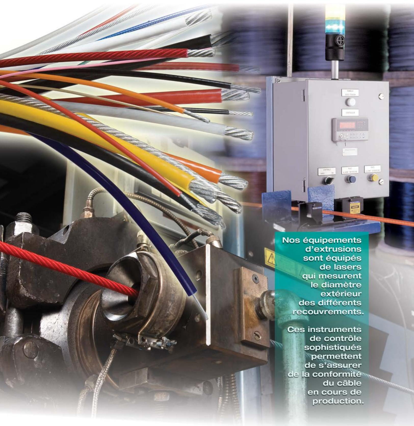
Nos équipements d'extrusions sont équipés de lasers qui mesurent le diamètre extérieur des différents recouvrements.
